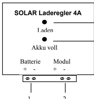
1. +/- Raccord de la batterie à plomb
